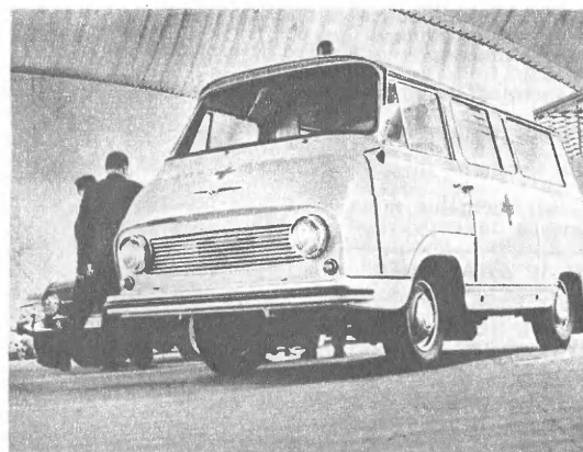
Санитарный автомобиль «Шкода-1203». Одна из модификаций микроавтобуса «Шкода». Четырехдверный несущий кузов с широкой задней дверью. Двигатель рабочим объемом 1221 см 3 развивает мощность 49 л. с. Максимальная скорость — 95 км/час.
