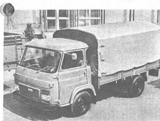
«Авиа А-15». Полутоннажный грузовик. Двигатель — четырехцилиндровый дизель мощностью 70 л. с. Большая гамма различных специализированных кузовов. Назначение — перевозка изделий легкой и пищевой промышленности.
